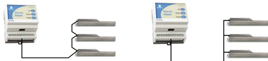
图 31: 正确的 RS485 电缆网络
